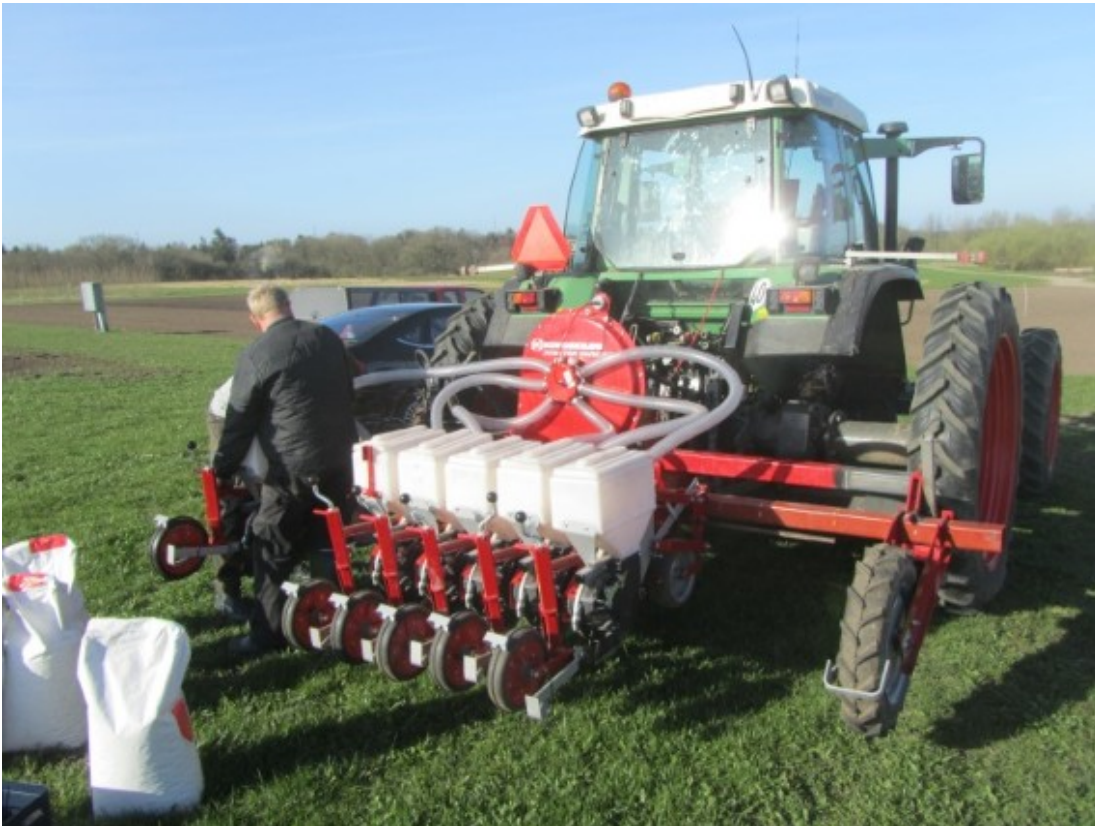
Billede 2. Udviklings-enkeltkornsmaskinen, 25-50 cm
